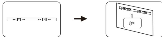
对准钻孔，用螺钉将挂梁固定于墙上；
