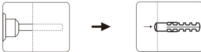
主机挂墙需要钻四个孔，首先选取适当位置在墙上钻第一个孔（深度40mm、直径8mm），根据挂梁孔的位置取剩余三个点钻孔，再将附带的塑料膨胀管敲入墙体孔内；
