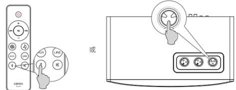
1. 短按遥控器 **蓝牙** 键或短按音箱上的音量调节旋钮切换至蓝牙输入,此时音箱蓝色指示灯快闪,进入待连接状态。
