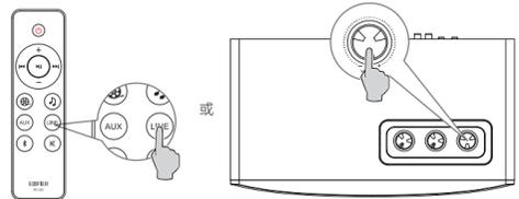
1. 短按音箱上的音量调节旋钮可进入AUX IN输入(绿色指示灯闪烁一下)或LINE IN输入(绿色指示灯闪烁两下)。
