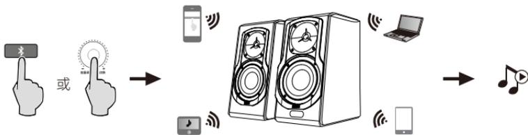
1. 按遥控器上的
