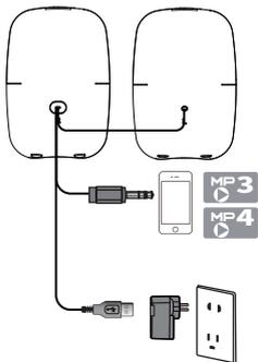
1. 如图所示,将USB线连接至供电设备(如USB接口电源适配器),再用音频线连接音源(如手机、MP3/MP4播放器等)。
