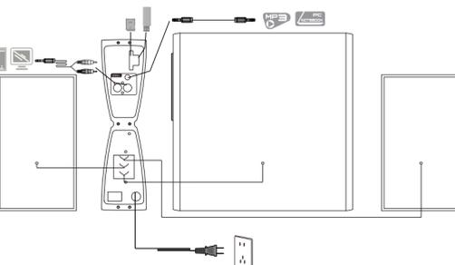
请注意音箱连接线的颜色, 黑色线接入红色接线夹, 白色线接入黑色接线夹, 接线前请确保功放后面板的电源开关处于关闭位置。
